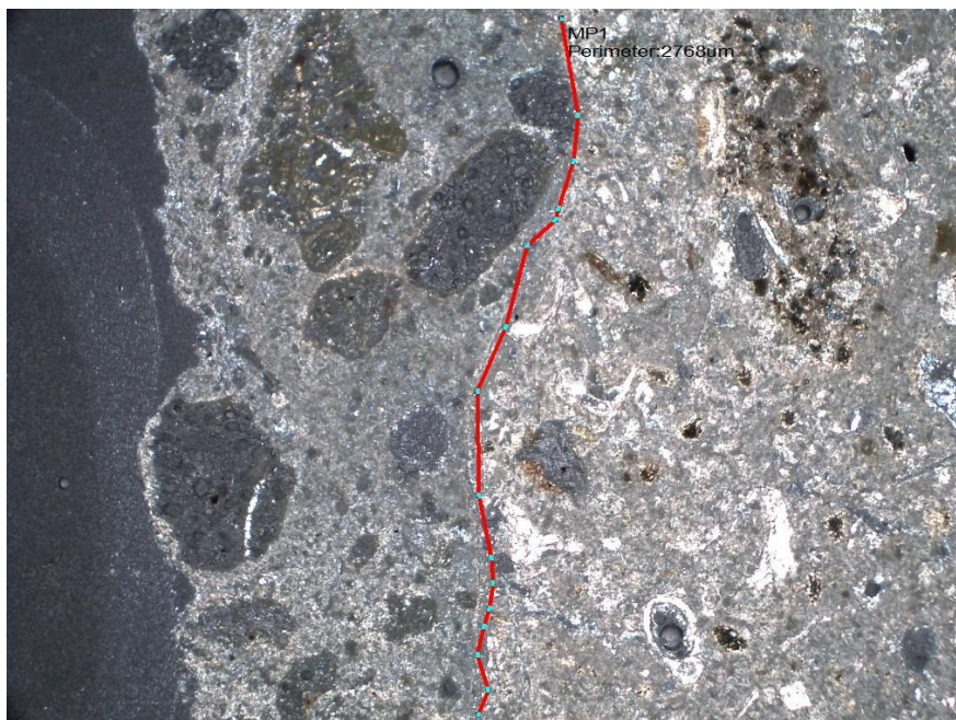
Campione 1 Microfotografia della sezione sottile (luce trasmessa, N// Ing:40x) Sono visibili due strati. In quello a sinistra (lato supporto murario) sono evidenti clasti di selce di più grande diametro rispetto a quelli di destra. Questo strato è da attribuirsi a rinzafo e/o arriccio e possiede colori di interferenza alti; in alto a destra si evidenzia la presenza di un bottacciolo con inclusioni di Belite
