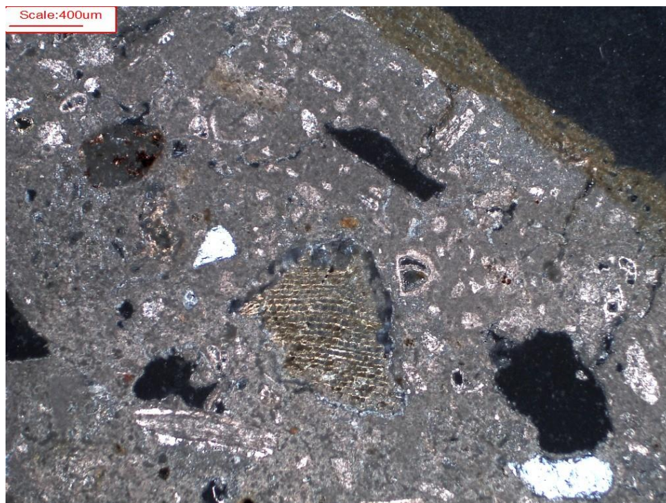
Campione 2 Microfotografia della sezione sottile (luce trasmessa, N// Ing:40x) Al centro grumo di legante stracotto
